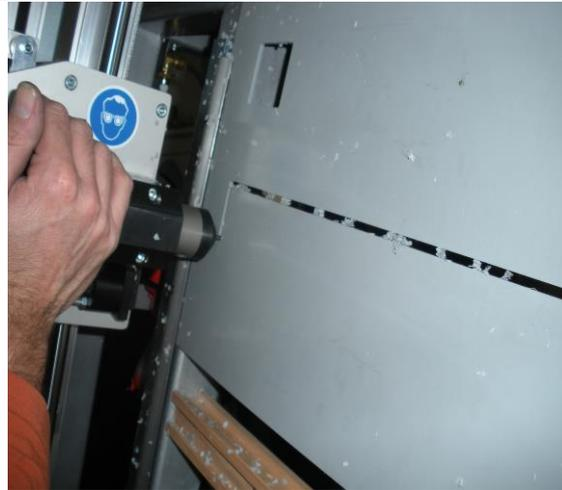
Fenster in jeder Form und Abmessung können massgenau ausgeschnitten werden. Die Schnittkanten sind präzise und müssen nicht nachträglich entgratet werden. Diese Ausschnitte werden neben der genauen Ausführung auch sehr kostengünstig hergestellt.
