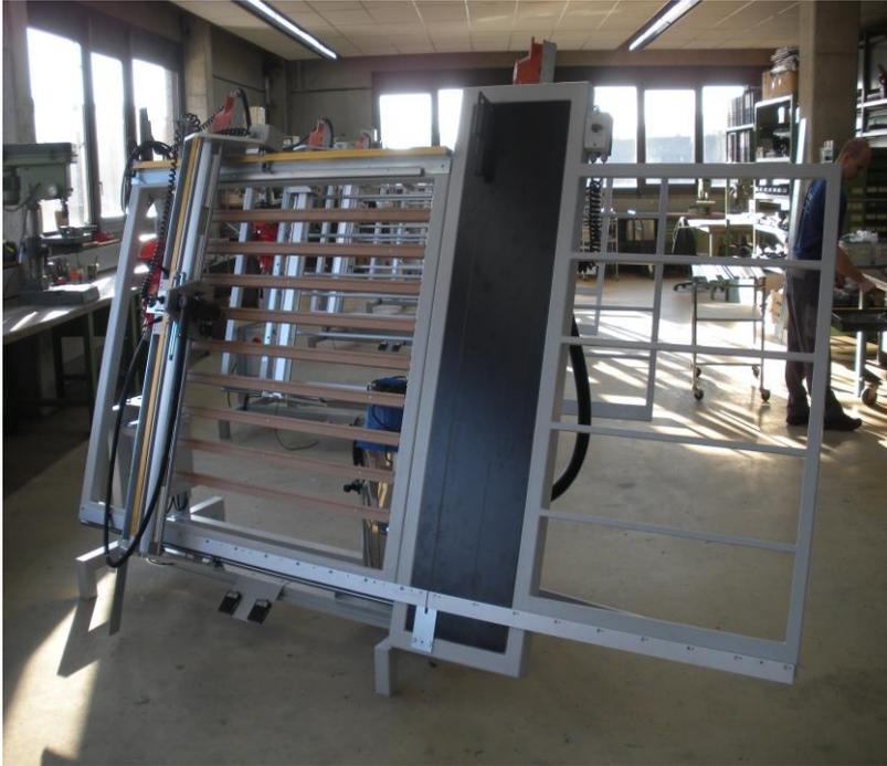
Seit Jahren wird die Plattenbearbeitungsmaschine FB 1200 im Schalttafelbau eingesetzt. Da sich die Plattenformate geändert haben, auch die Materialstärken zum Teil verändert sind, wurden an dieser bewährten Maschine in der Neuauflage einige Änderungen vorgenommen.
